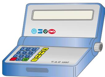
Il lettore guasti V.A.G 1552 è concepito come un maneggevole dispositivo di supporto. Comandi e funzioni sono identici al V.A.G 1551. Manca unicamente la funzione di stampa, che è stata tralasciata per una maggiore maneggevolezza del dispositivo.
